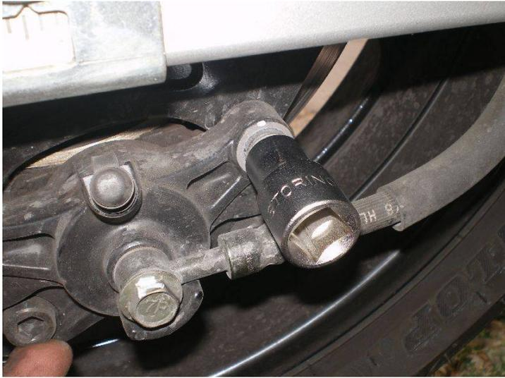
...sfilare i bulloni di fissaggio e rimuovere la pinza, ricordandosi di inclinare la pinza e fare leva sul disco per allargare i pistoncini...
