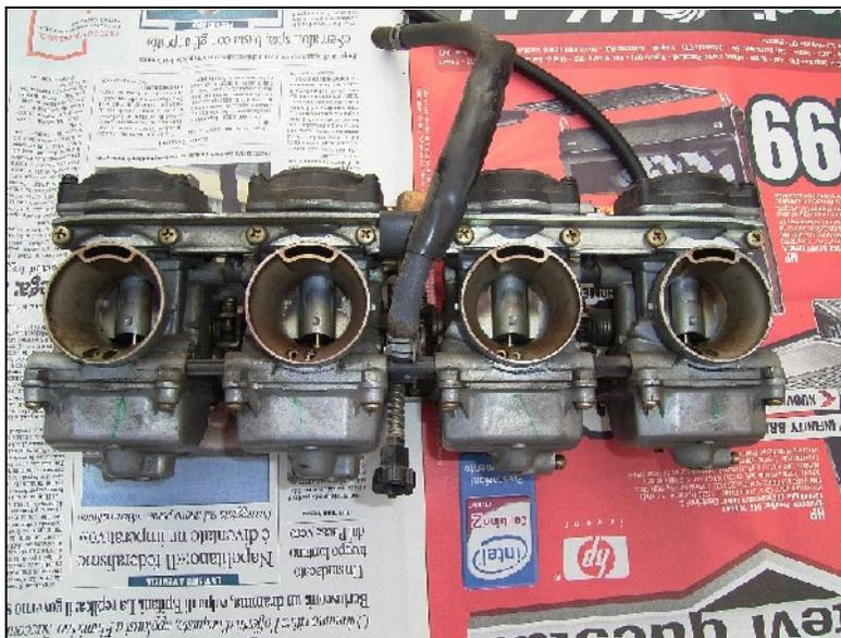
Sotto c'è la molla della valvola a saracinesca e se non si presta attenzione, ci si potrebbe trovare con i pezzi sparsi in giro. Una delle viti del carburatore N°4 fissa
