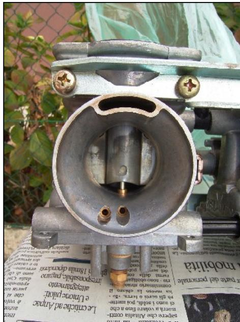
fine di ripristinare l'altezza corretta. A questo punto si può chiudere la parte inferiore del carburatore prestando attenzione al verso del condotto di scarico della benzina nella vaschetta.
