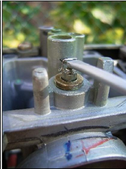
Ora che è tutto smontato puliamo i vari pezzi con del diluente e una volta finito si può procedere al rimontaggio, alla prearatura e al collaudo. Prima di cominciare il rimontaggio verificare la valvola di chiusura della benzina scorra nella sua sede perfettamente e senza intoppi. In caso contrario avvolgere un po' di carta abrasiva sul codolo della punta da trapano da 4,25 mm e pulire delicatamente
