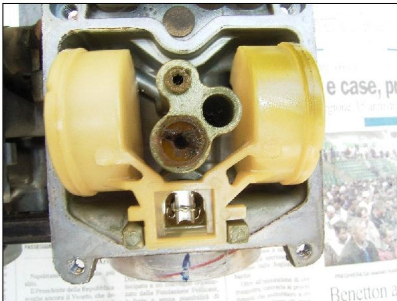
vaschetta è piena. Nel caso la punta fosse rovinata è necessario sostituire l'intero componente. Verifichiamo anche che il pistoncino a molla posto nel retro della valvola
