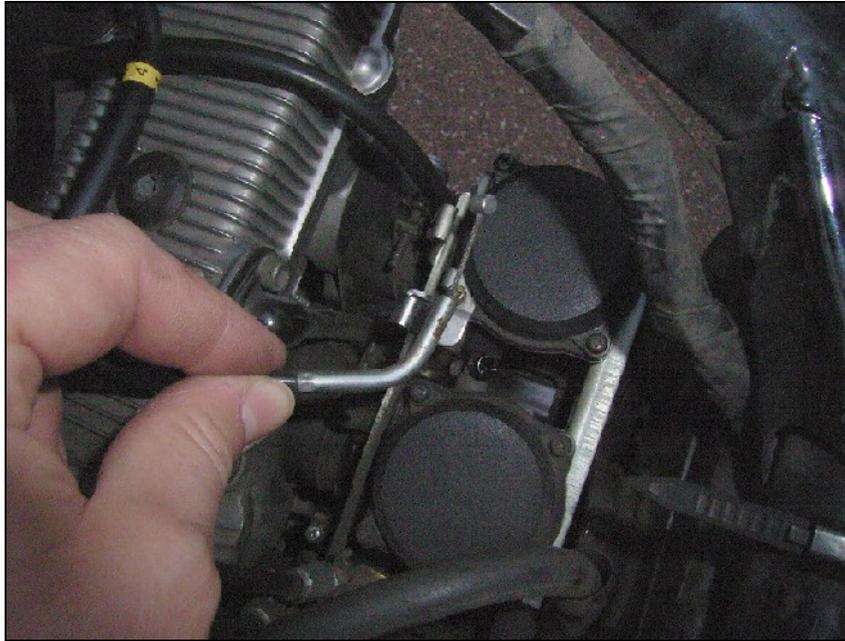
Ho cominciato smontando sella, serbatoio, fiancate con codone e coperture dell'air box, dopodiché ho scollegato dall'air box il tubo di sfiato dei vapori dell'olio. E' necessario togliere il coperchio dell'air box perché altrimenti non si riesce ad estrarre il gruppo di carburatori. Ho così preso al volo l'occasione per sostituire il filtro aria in carta con uno in tessuto della BMC.
