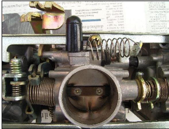
staffa di collegamento dei dispositivi di arricchimento e della relativa molla. Mettere tre rondelle di plastica tra corpo carburatore e staffa e le altre tre tra staffa e vite e fissare il tutto con le viti. Rimontare
