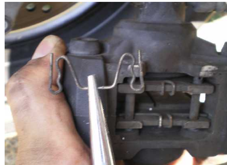
...cominciamo con il rimuovere la copiglia di sicurezza con la pinza a becchi....
