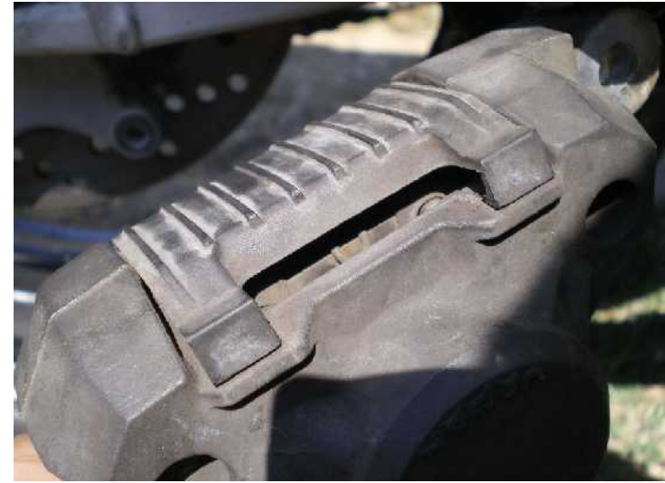
Rimuovere il coperchietto in plastica posto sulla parte inferiore della pinza....
