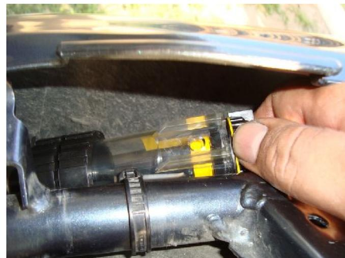
Come potete vedere, anche se lo spazio a disposizione non è tantissimo si riesce ad agire sulla ghiera di regolazione abbastanza agevolmente. Possiamo passare alla fase successiva: il montaggio dei tubi del depressore.
