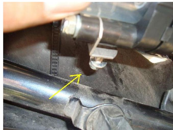
Ecco il segno di cui parlavo prima: lo useremo per posizionare la punta del trapano per il foro di fissaggio.
