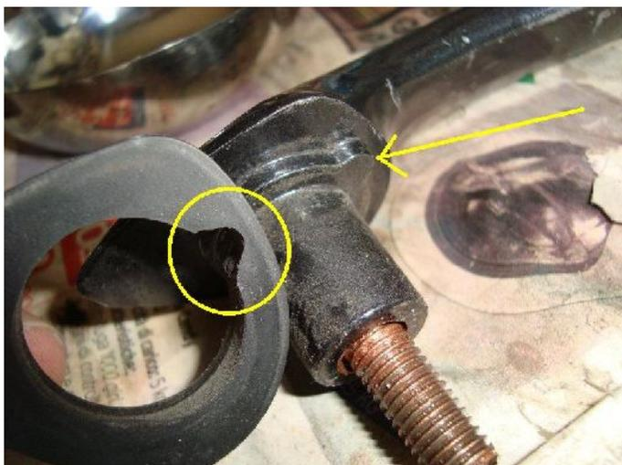
Ecco un particolare del maniglione e del relativo distanziale in gomma. Come vedete in quest'ultimo c'è un incavo per il corretto posizionamento. Tenetelo presente nel rimontaggio.
