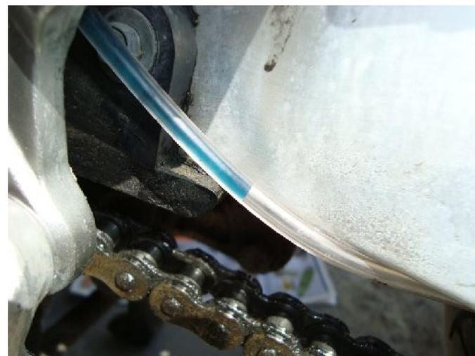
Per velocizzare l'operazione possiamo soffiare sul tubicino che esce dal lato del serbatoio. Aumentando la pressione nel circuito l'olio scenderà più velocemente.
