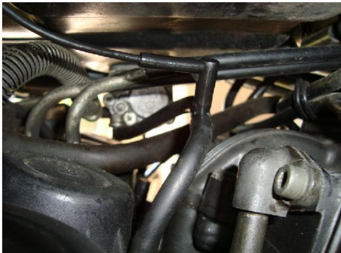
Innestiamo la pipetta sul raccordo a "T" appena montato.
