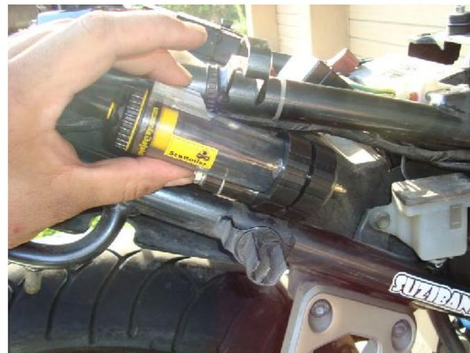
Ora che abbiamo rimosso il codone proviamo a posizionare il serbatoio dello Scottolier per studiare un posto ideale per la collocazione.
