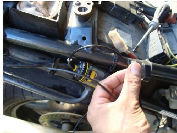
Inseriamo nella parte superiore del serbatoio il tubicino nero. Dovremo farlo passare lungo il telaio fino al motore in prossimità del rubinetto benzina.
