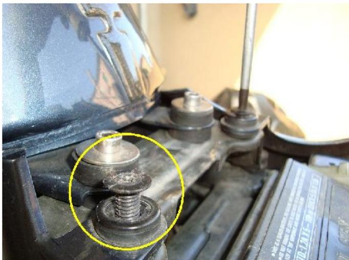
Adesso passiamo alle ultime viti che fermano il codone, quelle in prossimità del serbatoio. Basterà allentarle, non è necessario rimuoverle completamente.
