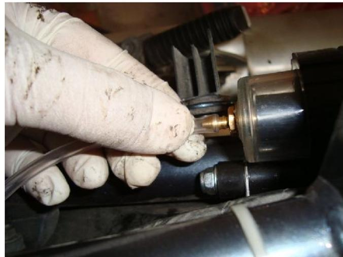
Preso la misura, ho tagliato il tubo e l'ho inserito nell'ugello del serbatoio dell'olio dello Scottailer.
