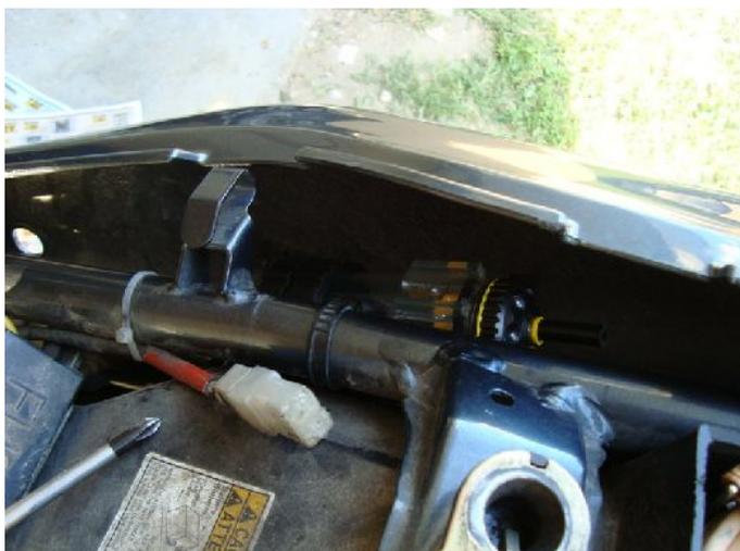
Mettiamo in posizione il codone senza fissarlo per vedere se quanto abbiamo montato interferisca con il montaggio. Appurato che è tutto ok, vediamo se e come si riesce ad agire per le regolazioni.
