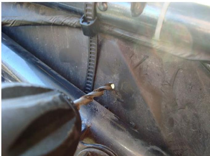
Con il trapano facciamo un foro del diametro della vite. L'operazione risulterà semplicissima trattandosi della plastica del sottocodone.
