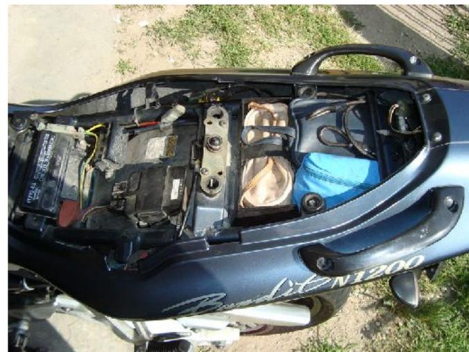
Rimontiamo il codone facendo le operazioni inverse a quelle viste prima. Ricordatevi di collegare il cavetto del fanalino posteriore.
