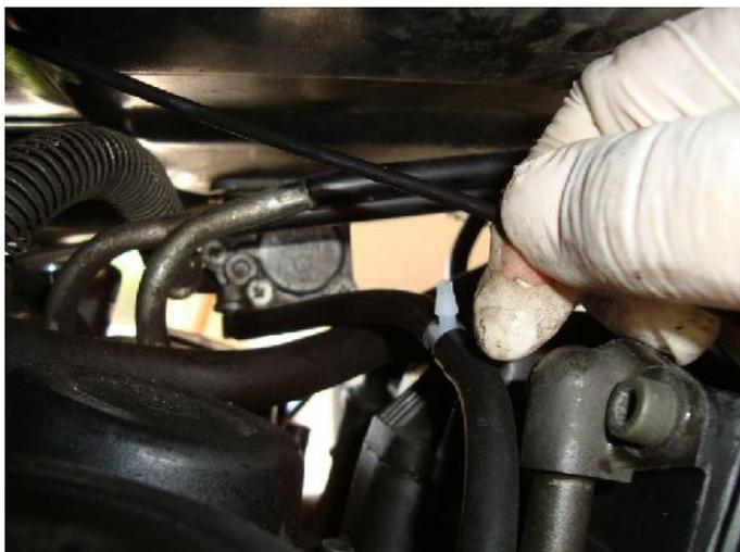
Rimontiamo il tubo del depressore e prendiamo la misura per tagliare il tubicino dello Scottoilier in eccedenza.
