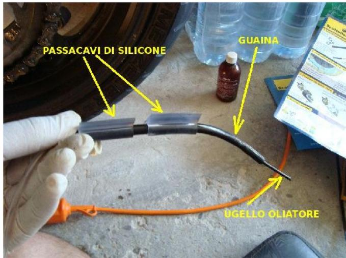
Nella foto vediamo la parte dell'ugello dell'oliatore. I due passacavi in silicone (compresi nel kit) li ho inseriti io ad una distanza approssimativa.
