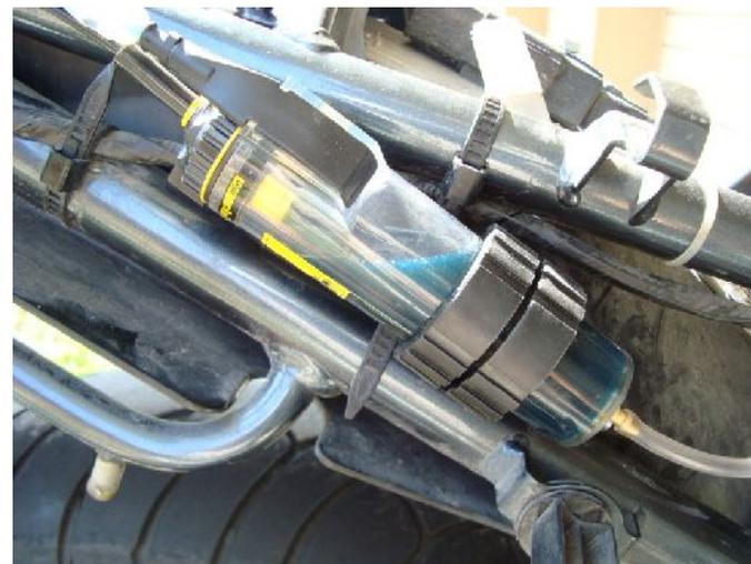
Nel dettaglio vediamo il serbatoio dell'olio che si sta riempiendo. Possiamo notare l'inclinazione di quest'ultimo che favorirà il deflusso per gravità.
