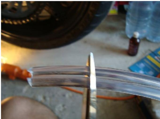
Per aiutarmi nel fissaggio ho utilizzato un pezzo della guaina in dotazione che presentava una scanalatura per far passare il tubo dell'olio.
