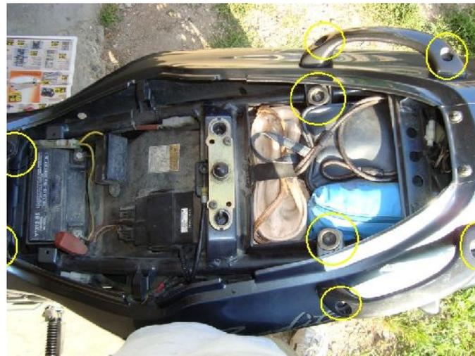
Rimuovete la sella per accedere alle viti che permettono la rimozione del codone (sono quelle cerchiare).
