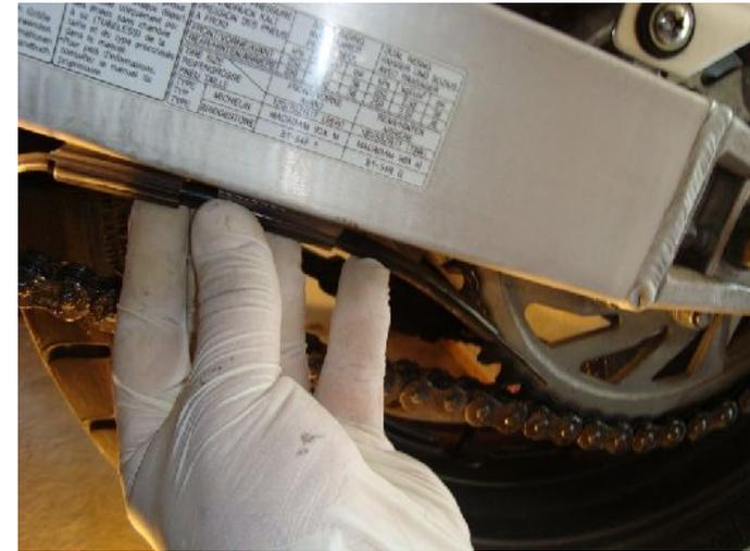
Proviamo a posizionare il tubo per vedere dove sia la posizione più indicata per far "cadere" l'ugello dell'oliatore nel punto migliore.
