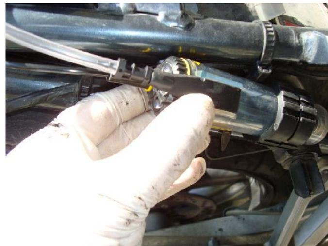
Ora dobbiamo riempire il serbatoio con l'olio in dotazione. Appliciamo il tappino con il tubo per il carico dell'olio
