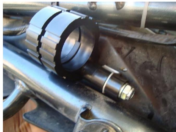
Fissiamo provvisoriamente il supporto in dotazione stringendo il bullone che avremo fatto passare dall'interno del parafango/sottosella (per capirci dove sta la ruota posteriore) ed infiliamo il contenitore dell'olio.
