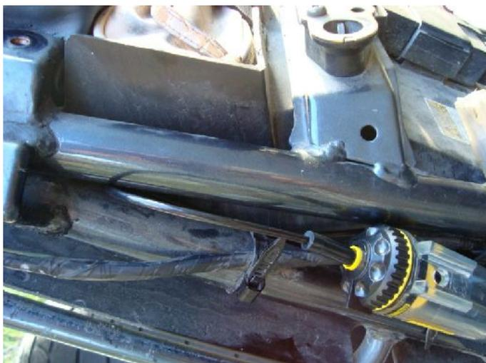
Facciamo passare il tubicino lungo il telaio evitando che questo si pieghi o intralci.
