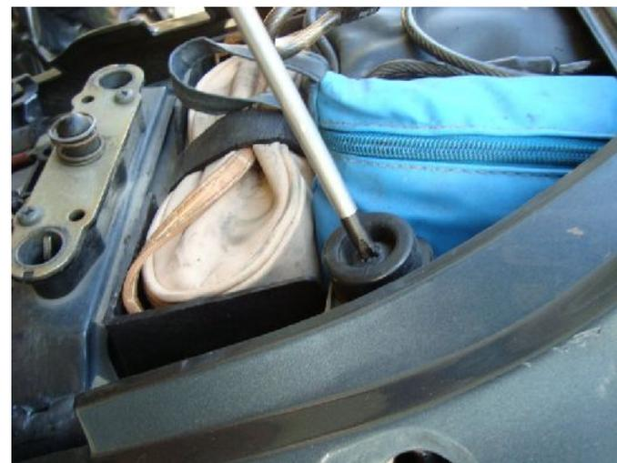
Adesso passiamo alle viti del sottosella. Rimuoviamo quelle che tengono il tampone in gomma...
