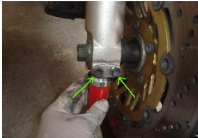
Adesso dobbiamo togliere il perno della ruota. Con la chiave da 12 allentiamo i bulloni che fungono da sicurezza. Non occorre rimuoverli.
