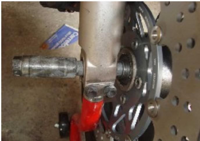
Una volta infilato il perno spingetelo più all'interno possibile cercando di tenere la ruota sollevata e più in asse possibile.
