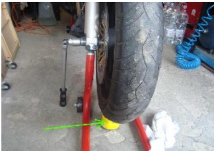
Il peso della ruota interferirà con l'estrazione del perno, quindi ponete qualcosa della giusta altezza sotto quest'ultima in modo che il suo peso non gravi tutto sul perno.
