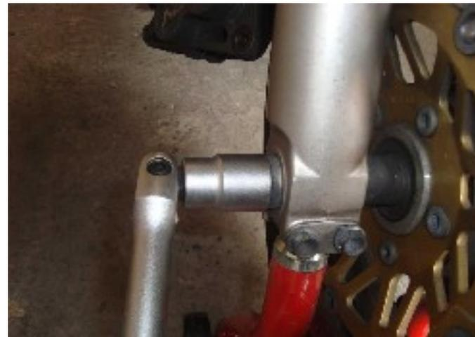
Adesso con la chiave da 22 svitiamo il perno ruota. Preparatevi spiritualmente all'operazione più difficile se siete da soli: la rimozione della ruota.
