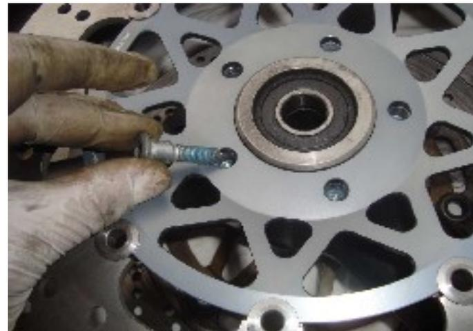
Montiamo il nuovo disco. Se ne avete mettete del frenafiletti sulle viti: io non ne avevo ma non ho rimosso quello già presente.
