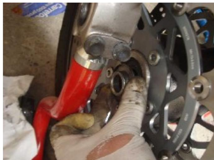
Posizionate il distanziale ed armatevi di pazienza: da soli tenere sollevata la ruota ed infilare il perno è una operazione complicata....
