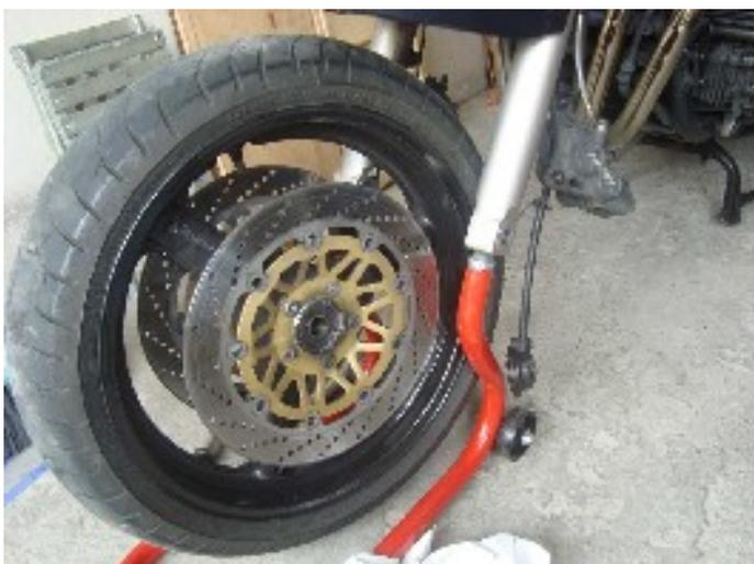
Sfilato il perno, togliamo la ruota e mettiamola su un tavolo per passare alla fase due dell'operazione: rimuovere i dischi freno.
