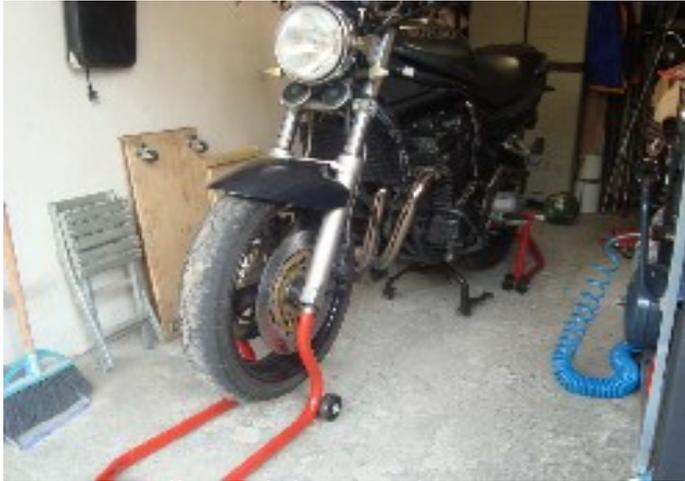
Cominciamo con il posizionare la moto in modo da poter operare liberamente sulla ruota. Io ho utilizzato dei cavalletti per moto. Se avete il cavalletto centrale potete alzare l'anteriore con un cricco posizionato sul basamento del motore.
