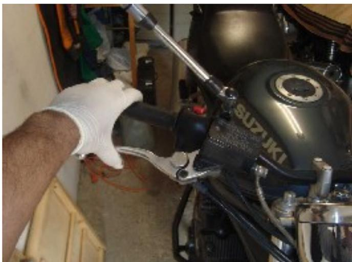
Terminato il montaggio delle pinze freno, pompate più volte la leva del freno per riportare in posizione i pistoncini della pinza. E' il caso che operiate anche uno spurgo dell'impianto frenante e meglio la sostituzione dell'olio. Fate riferimento alla mia [guida alla sostituzione del liquido dei freni](#).
