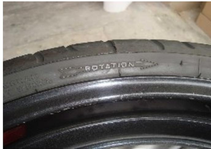
Verificate il senso di rotazione dello pneumatico per essere certi di montarlo nel verso giusto.
