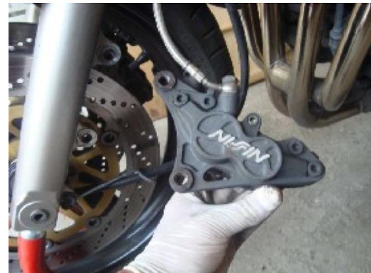
Rimuoviamo la pinza e posizioniamola in modo che non interferisca con le operazioni successive. Ripetiamo le ultime operazioni anche per l'altra pinza.
