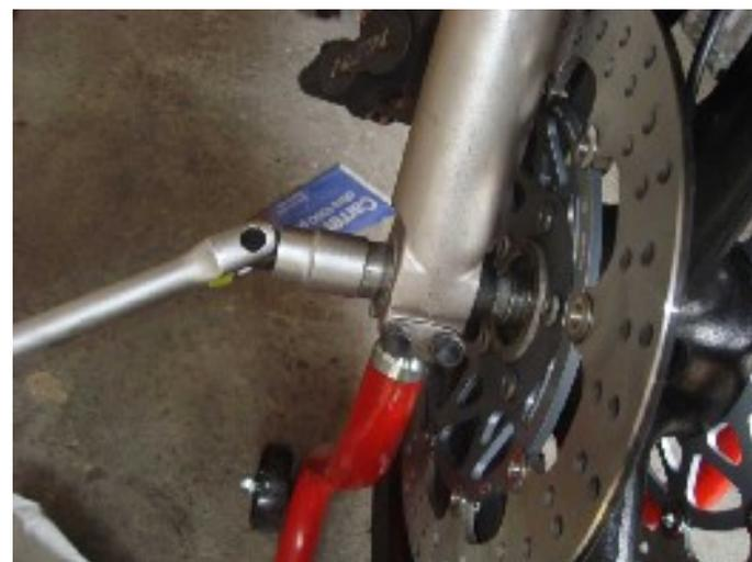
Avvitare il perno fino in fondo, se avete la dinamometrica la coppia di chiusura è 100 Nm
